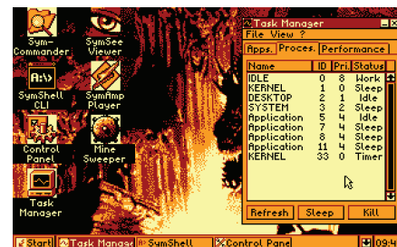
Prozessliste im Taskmanager: Der Kernel erlaubt echten Multitasking-Betrieb von bis zu 32 Prozessen.
