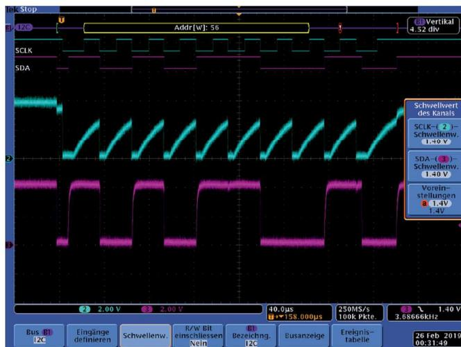
Obwohl das analoge SCLK-Signal sich nicht geändert hat, ist das digitalisierte wieder fast normal. Der Dekoder erkennt das Byte wieder. Da die Schwellwerte in der Schaltung und am Logic Analyzer oft unterschiedlich sind bzw. sich unterschiedlich verhalten, kann es sein, das man am LA keine Fehler erkennen kann oder umgekehrt am LA kein plausibles Bild erscheint. Bei solchem Verhalten ist ein Griff zum Oszilloskop immer ratsam.
