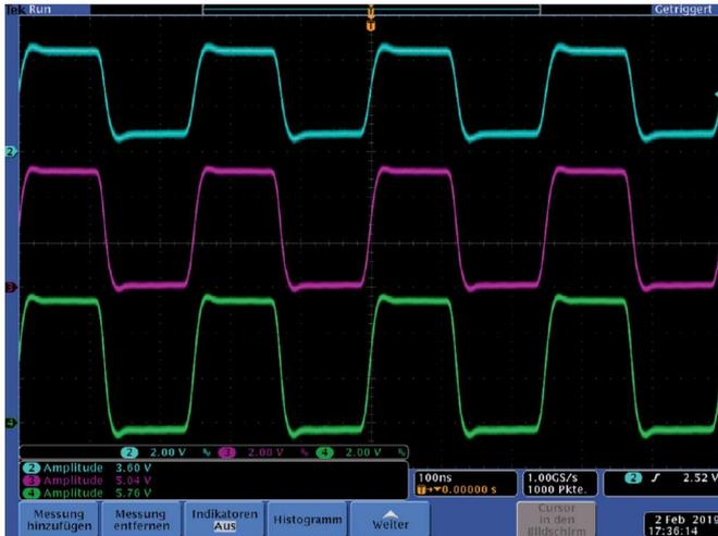
Im obigen Bild ist nur der Tastkopf des mittleren Kanals richtig kompensiert. Hier ist klar zu sehen, dass alle Kanäle unterschiedliche Amplituden haben. Das ist auch in den Messungen links unten angezeigt. Der obere Kanal zeigt ca 25% zu wenig an, der untere ca. 15% zu viel. Unter solchen Bedingungen misst man Mist!
