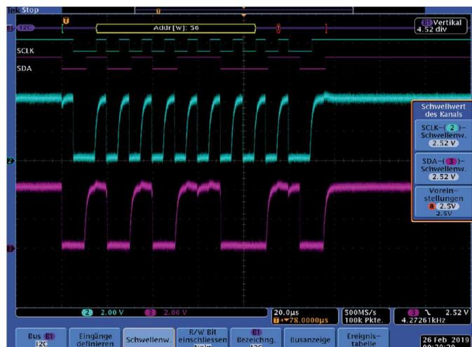
Die Mitte zeigt die analog gemessenen Signale, darüber sind die vom Oszilloskop digitalisierten und wiederum darüber das übertragene und ausgewertete Byte zu sehen. Beispielsweise durch einen Lötfehler, durch ein falsches oder ein defektes Bauteil kann der Pullup-Widerstand zu groß werden. Dadurch wird der Strom durch den Widerstand kleiner als erwünscht.
