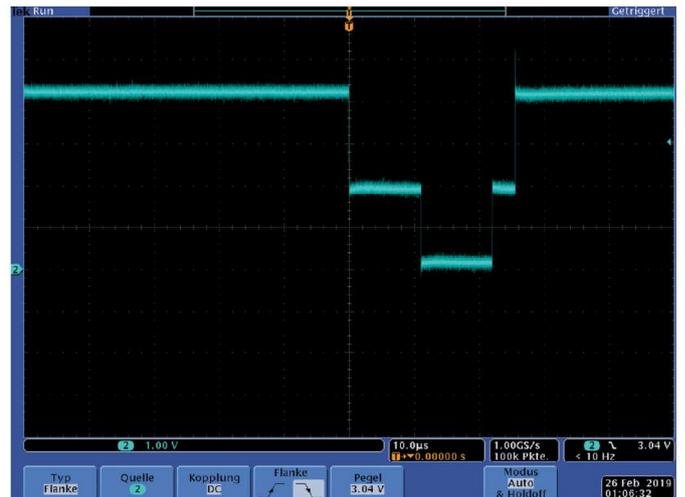
Im Bild ist zu sehen, wie zwei Ausgänge mit unterschiedlichen Pegeln die Spannung ziemlich genau in die Mitte zwingen. Haben beide Ausgänge den gleichen Pegel, ist alles gut. Dass hier die Spannung in der Mitte liegt, ist dem Zufall geschuldet und hängt von vielen Parametern ab. Treiberschaltung, Versorgungsspannung, Temperatur des IC sind nur die wichtigsten davon. Daher ist keine Aussage möglich, wie ein solcher Fehler sich in der Realität verhält.
