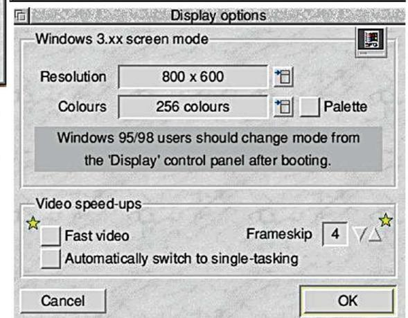
!PCPro ist das Konfigurations- und Steuerprogramm zur PC Prozessor Karte, hier die Version 3.06 der von Aleph One hergestellten Software. Die zahlreichen Einstellmöglichkeiten zeigen die Möglichkeiten der Karte. Im Fenster bettet sich das MSDOS- oder Windowsprogramm unkompliziert in die GUI von RiscOS ein. Ein Datenaustausch ist über die Zwischenablage möglich.
