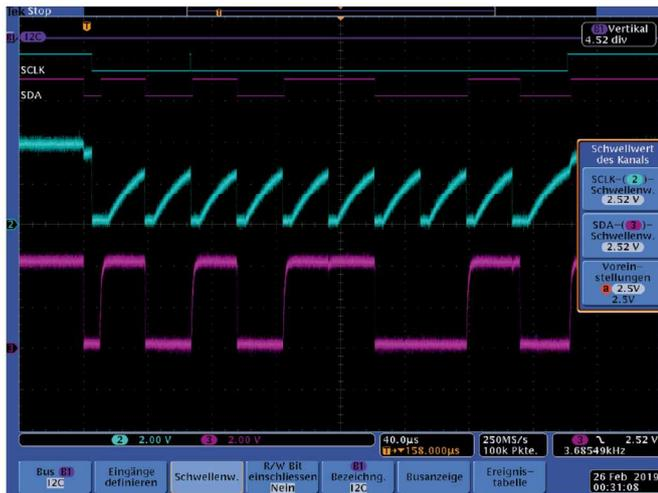
Die steigende Flanke des oberen SCLK Signal kommt nur sehr langsam nach High. Es erreicht den Endwert während der Übertragung gar nicht mehr. Das digitalisierte SCLK Signal bleibt die ganze Zeit Low, der I2C-Dekoder erkennt nichts. Ein etwas veränderter Schwellwert – also die Entscheidungsschwelle für Low oder High – verändert das Ergebnis enorm:
