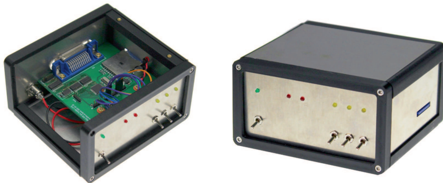
Der GPIB Disk Emulator-Nachbau der Autoren. Getestet wurde der Nachbau an verschiedenen HP85 und HP86B-Modellen. Schalter links/LED grün: Ein/Aus; Mitte, rote LEDs: Statusanzeigen; Schalter rechts/LEDs gelb: binärcodierte Auswahl Diskimage 0-7. In der rechten Gehäusesseite ist die Öffnung des SD Card Readers erkennbar. Zur Spannungsversorgung ist ein gut stabilisiertes externes 5V-Netzgerät erforderlich. Für die Realisierung des Gehäuses kamen openSCAD, LibreCAD, Cura und Estlcam zum Einsatz, gefolgt von einem Rückgriff auf einen i3Berlin 3D-Drucker, eine Gravograph VA11 und eine isel Flachbett CNC-Fräse.
