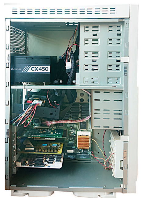
Seitenansicht des Rechners. Gut zu erkennen: Das behelfsmäßig angebrachte Gehäuse für den ATX2AT-Konverter.
