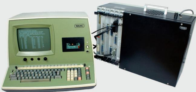
Die Tastatur wurde in die Konsole und das Netzgerät in die Zentraleinheit integriert. Ansonsten waren die Ausführungsgeschwindigkeit und das BASIC nahezu identisch; die bisherigen Ein-/Ausgabebaugruppen und Peripheriegeräte konnten weiter verwendet werden.
