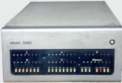
Ein Mehrbenutzersystem für bis zu 16 serielle Terminals (modifizierte Teletype-Geräte), das als Konkurrent zur DEC PDP-8 gedacht war. BASIC oder FORTRAN mussten nach dem Einschalten von Lochstreifen oder Kassette geladen werden, was bei BASIC über Lochstreifen etwa 40 Minuten dauerte.
