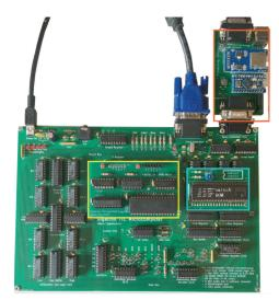
Das fertig aufgebaute Gigatron mit den Erweiterungen
