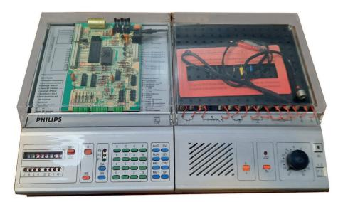
Das Philips Masterlab mit angeflanschter Experimentierbox
