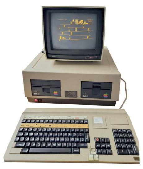
Der Basis-108: Ein erweiterter Apple-II kompatibler Rechner im soliden Gehäuse
