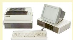
Während die früheren Computer aus zwei Einheiten bestanden, nämlich einer Prozessoreinheit und einer Speichereinheit, gelang es den Ingenieuren beim ES-1842 schließlich, den gesamten XT-Computer in ein Gehäuse zu integrieren. Dieser Computer ist recht selten, es wurden nicht sehr viele davon produziert. Es gibt Informationen, dass es etwa 10.000 Stück waren und noch weniger haben bis heute überlebt. Vielleicht liegt das daran, dass dieser Rechner gemäß der vor-
