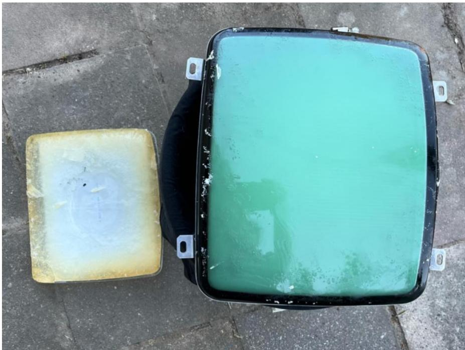
Links: Abgetrennte Schutzscheibe mit Klebstoff, Rechts: Bildröhre
