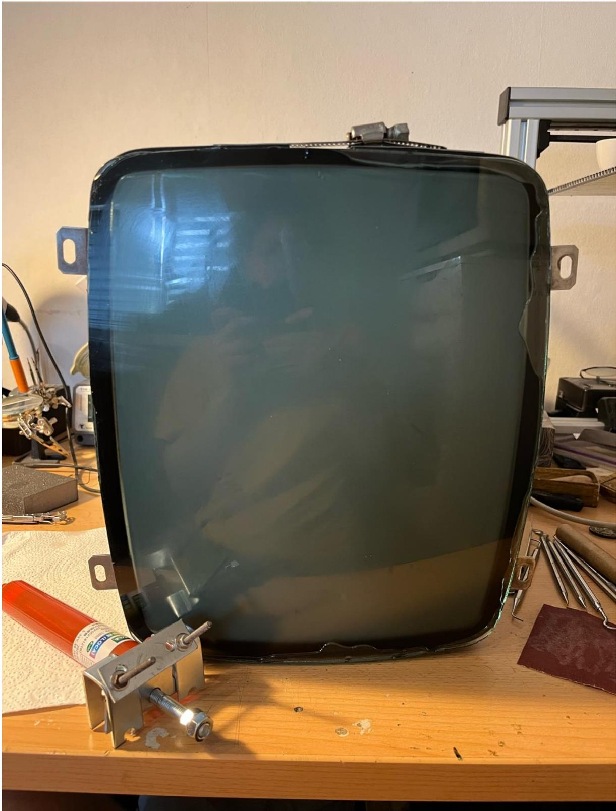
Auf der Seite liegende Röhre mit unvollständig eingefülltem Rand
