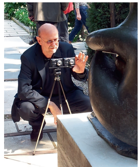
Aufnahme mit zwei Kameras, die im Augenabstand auf einer Schiene montiert sind.
