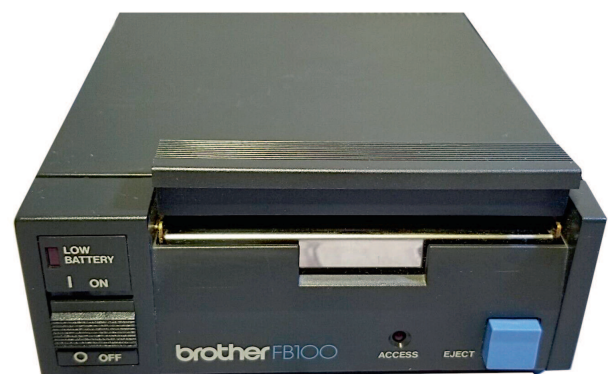
Das Brother FB100 Laufwerk gehört eigentlich an Strickmaschinen
