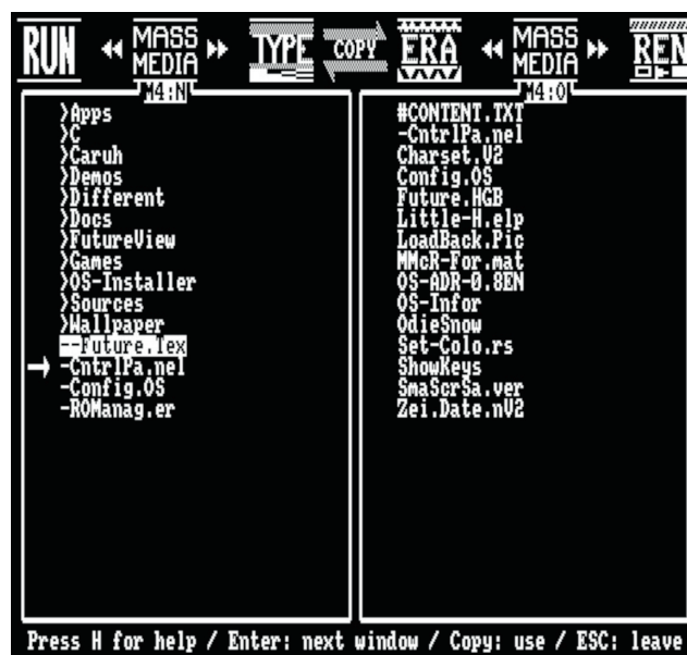
Die Massenspeicher Shell erlaubt es, auf SD-Karte bis zu 2 TByte zuzugreifen. Die notwendigen Datei-Funktionen sind integriert.
